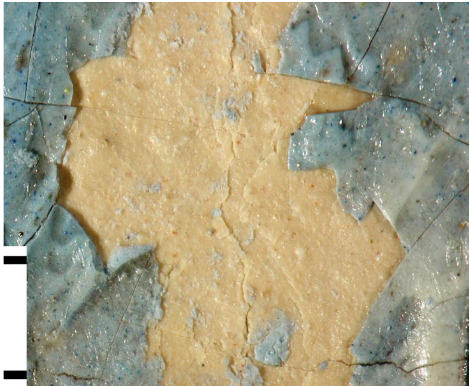
Abb. 8 Cremefarbene Grundierung, Mikroskopaufnahme (M = 1 mm)
